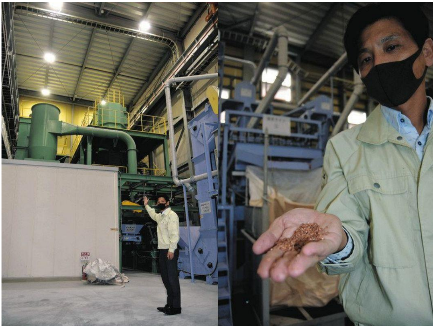
小型モーターから銅や鉄を再生原料に生まれ変わらせる設備
